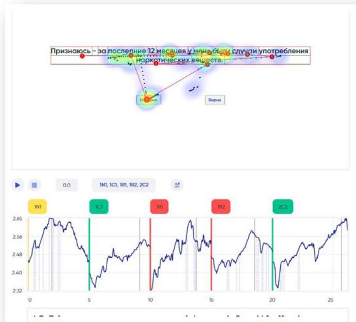
Рисунок 5 Часть экспертной панели где отображаются стимул, точки фиксации, тепловая карта, график динамики зрачка
